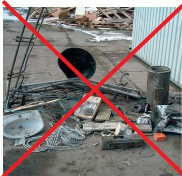
Große Eisenteile und Sperrmüll führen zu Maschinenschäden in den Zerkleinerungsanlagen
